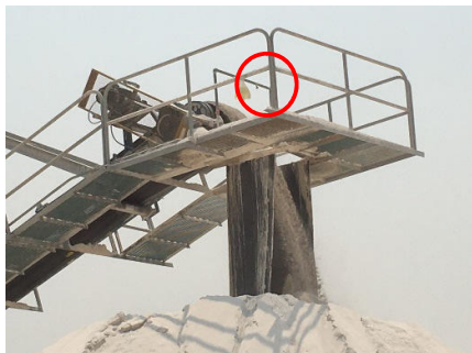
รูปที่ 2-21: ระบบสเปรย์น้ำโรงโม่
