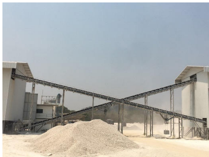
รูปที่ 2-19: การปิดคลุมสายพานลำเลียง
